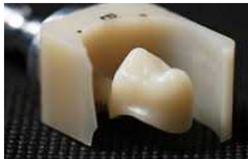
設計に基づき削り出し (CAM)
